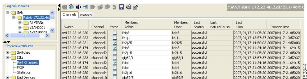
図 8-17 Fabric Manager のポートチャネルの概要
