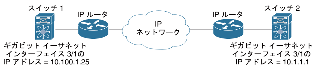
図 2-18 各ギガビット イーサネット インターフェイスへのプロファイルの割り当て
