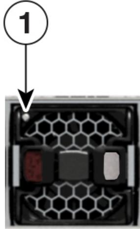
図 112: ファントレイ LED : Cisco 8202-32FH-M および Cisco 8212-48FH-M ルータ
