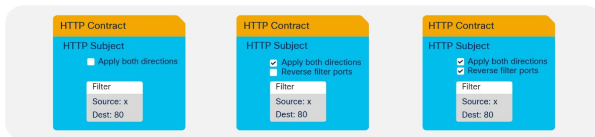
図 69 [両方向に適用 (Apply Both Directions) ] オプションと [フィルタ ポートの反転 (Reverse Filter Ports) ] オプションの併用
