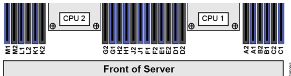
図 20: DIMM スロットの番号付け
