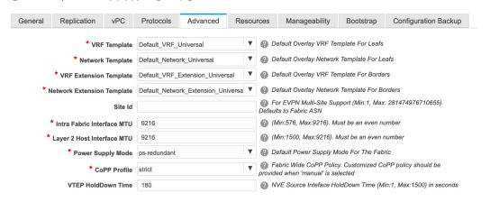
VRFテンプレートおよびVRF拡張テンプレート: VRFを作成するためのVRFテンプレートと、他のファブリックへのVRF拡張を有効にするためのVRF拡張テンプレートを指定します。
