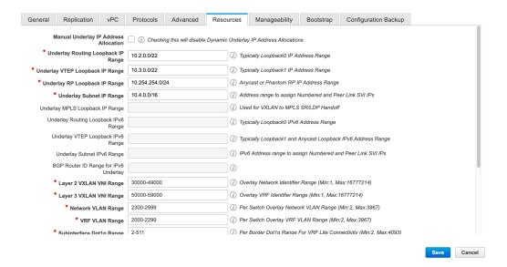
[手動アンダーレイ IP アドレスの割り当て(Manual Underlay IP Address Allocation)]: VXLAN ファブリック管理を移行する場合は、このチェックボックスをオンにしないでください。
