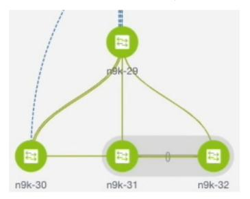
トポロジは、eBGP アンダーレイが有効化された VXLAN ファブリックを表示します。DCNMでは、[Easy\_Fabric\_eBGP] テンプレートを持つファブリックが作成されます。1つのスパインスイッチ(n9k-29)と3つのリーフスイッチ(n9k-30、および vPC スイッチペア:n9k-31 とn9k-32)がインポートされています。
