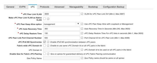
[vPC ピア リンク VLAN (vPC Peer Link VLAN)]: vPC ピア リンク SVI に使用される VLAN です。
