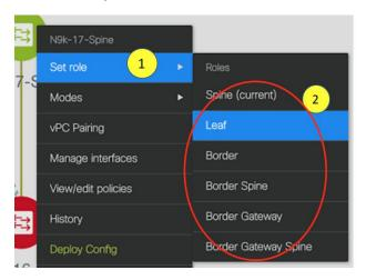
表示用に階層レイアウトを選択すると([アクション(Actions)] パネルで)、トポロジはロールの割り当てに従って自動的に配置され、リーフ デバイスが下部に、スパイン デバイスが上部に接続され、境界デバイスが上部に配置されます。
