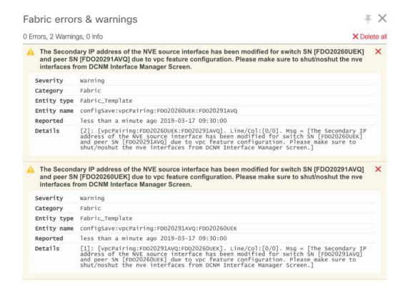
解決するには、[制御(Control)]>[インターフェイス(Interfaces)] 画面に移動し、nve インターフェイスでシャットダウン操作を展開してから、No Shutdown 構成を実行します。これを次の図に示します。上矢印は No Shutdown 操作に対応し、下矢印はShutdown 操作に対応します。
