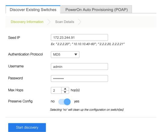
2. [検出の開始(Start discovery)] をクリックします。[スキャン詳細(Scan Details)] ウィンドウが間もなく表示されます。[最大ホップ(Max Hops)] フィールドに2が入力されているため(デフォルト)、指定されたIPアドレス(リーフ91)を持つスイッチとそのスイッチからの2つのホップが[スキャン詳細(Scan Details)] の結果に入力されます。
