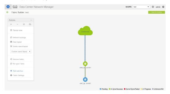
ファブリック トポロジ ウィンドウに移動し、**[アクション(Actions)]** パネルから **[スイッチの追加(Add switches)]** オプションをクリックします。**[**インベントリ管理(Inventory Management)] ウィンドウが表示されます。
