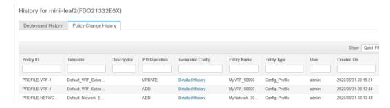
ポリシーの [ポ**リシー変更履歴(Policy Change History**)] タブで、**[生成された構成 (Generated Config)**] 列の **[詳細な履歴(Detailed History**)] をクリックして、前後の生成された構成を表示します。
