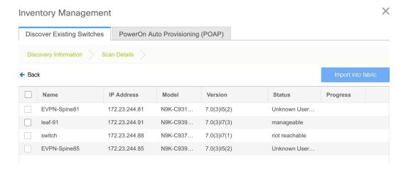
3. DCNM がスイッチに対して正常なシャロー検出を実行できた場合、ステータスに [管理性 (Manageable)] と表示されます。適切なスイッチの横にあるチェックボックスをオンにして、[ファブリックにインポート (Import into fabric)] をクリックします。
