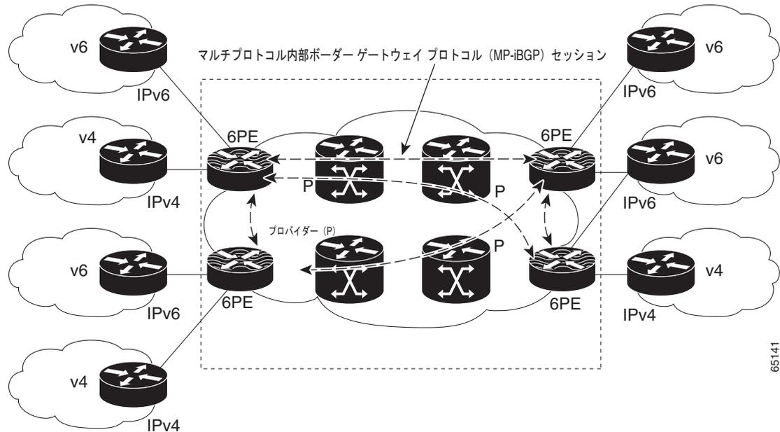
CE ルータに接続している 6PE ルータ上のインターフェイスは、カスタマーの要件に基づいて IPv6 トラフィック、IPv4 トラフィック、または両方のタイプのトラフィックを転送するように設定できます。6PE ルータは、MPLS クラウドを介して 6PE ピアから学習した IPv6 到達可能性情報をアドバタイズします。サービスプロバイダーは、6PE インフラストラクチャを介して、登録済み IPv6 プレフィックスから IPv6 プレフィックスを委任できます。それ以外の場合は、CE ルータに対する影響はありません。
