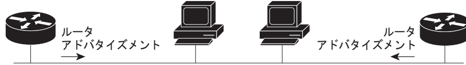
図 13 IPv6 ネイバー探索 : RA メッセージ
