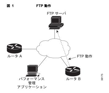
接続応答時間は、TCP上で FTP を使用してリモート FTP サーバからルータ B にファイルをダウンロードするのに要する時間を測定して算出されます。この動作は IP SLA Responder を使用しません。
