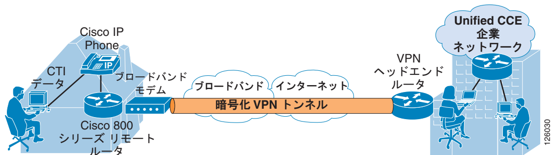
図 2-22 Business Ready Teleworker Solution を介して展開された IP Phone を使用するリモート エージェント
