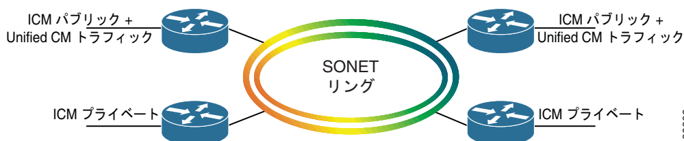
図 2-14 正常に動作しているときの SONET リングに基づくネットワークアーキテクチャ
