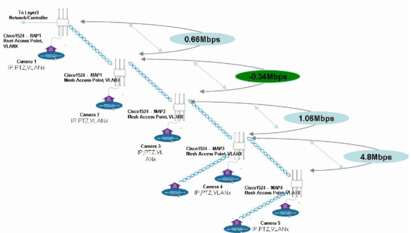
ワイヤレスメッシュネットワークに Cisco 2500IP ワイヤレスカメラを追加すると、バックホール帯域幅の複雑さが増加します。Cisco 2500IP ワイヤレスカメラは、SNR 値が 30 db 以上に維
