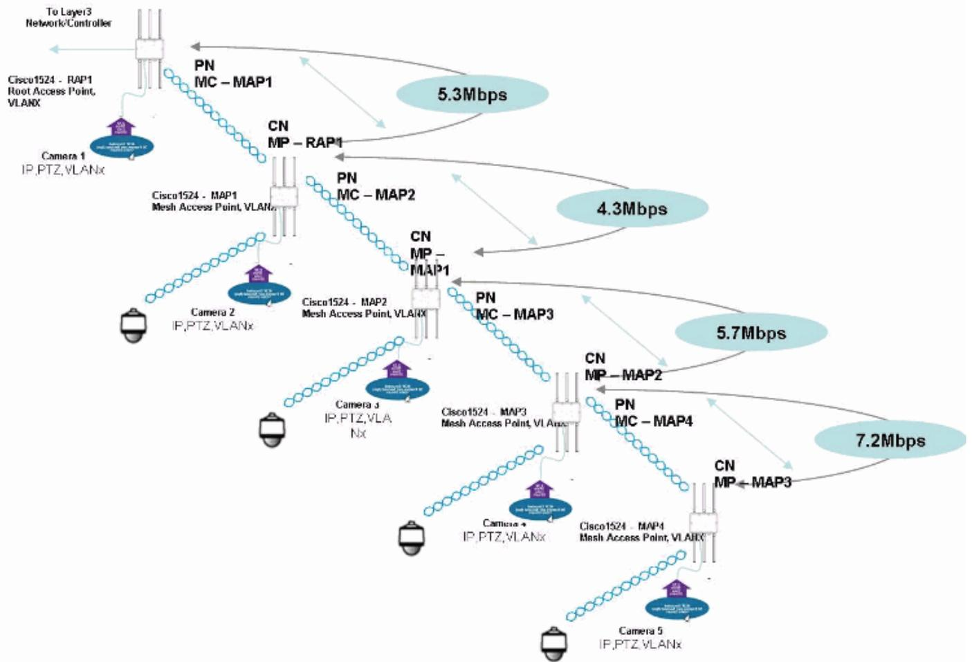
すべてのワイヤレスカメラを、有線接続カメラの設定に合わせることはできるでしょうか。この図は、類似の設定による影響を説明しています。
