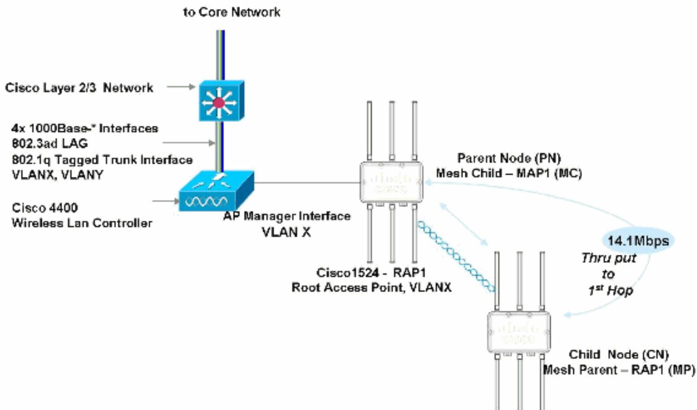
ネットワークへの最終アクセスポイントを追加し、すべてのMAPがコントローラに接続されたことを確認します。次の図には、親/子関係とデータスループットが示されています。
