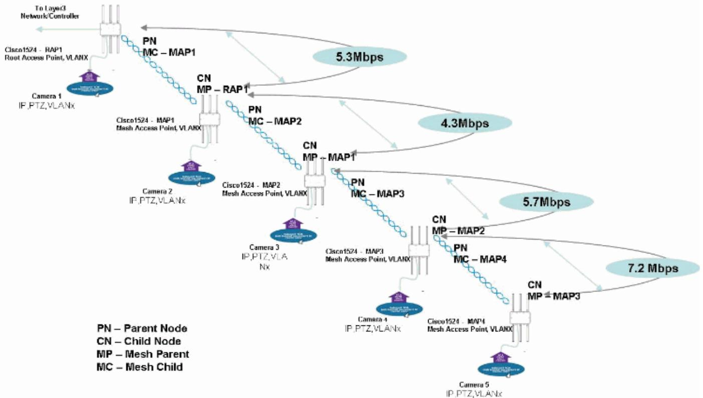
各ホップで1台のカメラを導入した場合、バックホールへの影響が見られます。第4ホップ (MAP4) から4CIF、30fps、2Mbitの構成のカメラを導入した場合、使用可能な帯域幅は7.2Mbpsです。カメラのトラフィックパスはパス内のアクセスポイントのバックホール無線を通過するため、これは、RAPの帯域幅にまで影響を与えます。
