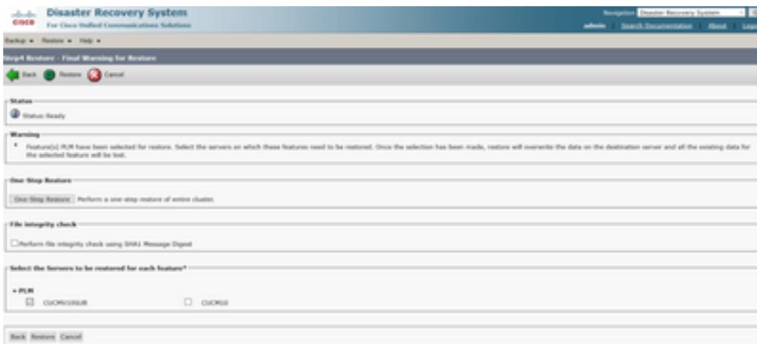
注:ワンステップ復元では、パブリッシャがすでに再構築されているか、新規インストールされている場合に、クラスタ全体を復元できます。このオプションは、復元用に選択したバックアップファイルがクラスタのバックアップファイルであり、復元用に選択した機能にパブリッシャノードとサブスクライバノードの両方に登録されている機能が含まれている場合にのみ表示されます。
