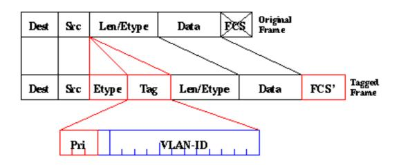
802.1Qフレームを識別するEtherTypeフィールドは0x8100です。12ビットのVLAN-IDに加えて、 3ビットはIEEE 802.1pプライオリティタギング用に予約されています。
