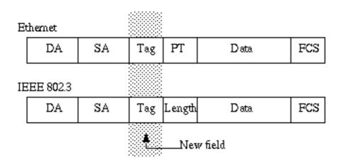
注:802.1Qトランクでは、1つのVLANがタグ付けされていません。この VLAN はネイティブ VLAN と呼ばれ、トランクの両側で同じ VLAN が設定されなければなりません。このようにして、タグのないフレームを受信したときに、そのフレームが属する VLAN を推測することができます。
