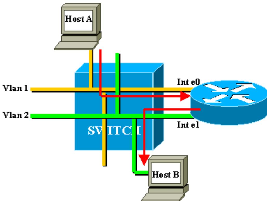
この図では、2つのVLANは2つの異なるイーサネットセグメントと見なされます。VLAN間トラフィックは、外部ルータを通過する必要があります。ホストAがホストBと通信する場合、通常はルータをデフォルトゲートウェイとして使用します。
