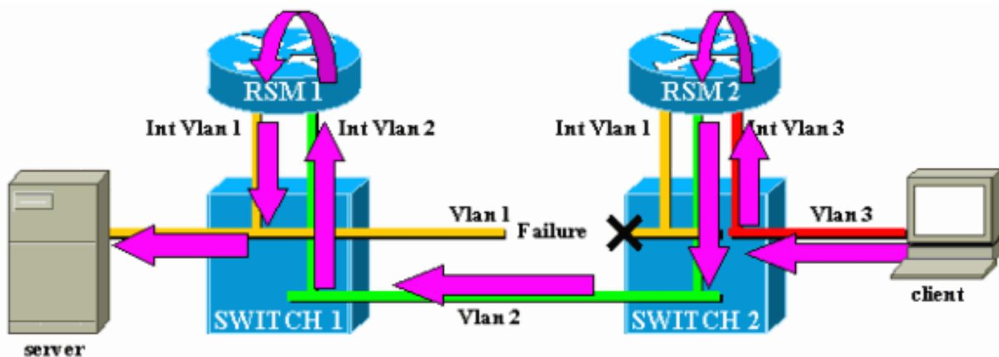
RSM autostateは、VLAN内に他のポートがアップしていない場合にのみ動作します。たとえば、VLAN1内の別のクライアントがスイッチ2に接続されている場合、またはインターフェイスVLAN1が定義されたシャーシ内のRSMがある場合、スイッチ1とスイッチ2の間のリンクに障害が発生しても、インターフェイスVLAN1は無効になりません。したがって、トラフィックは再び混乱します。
