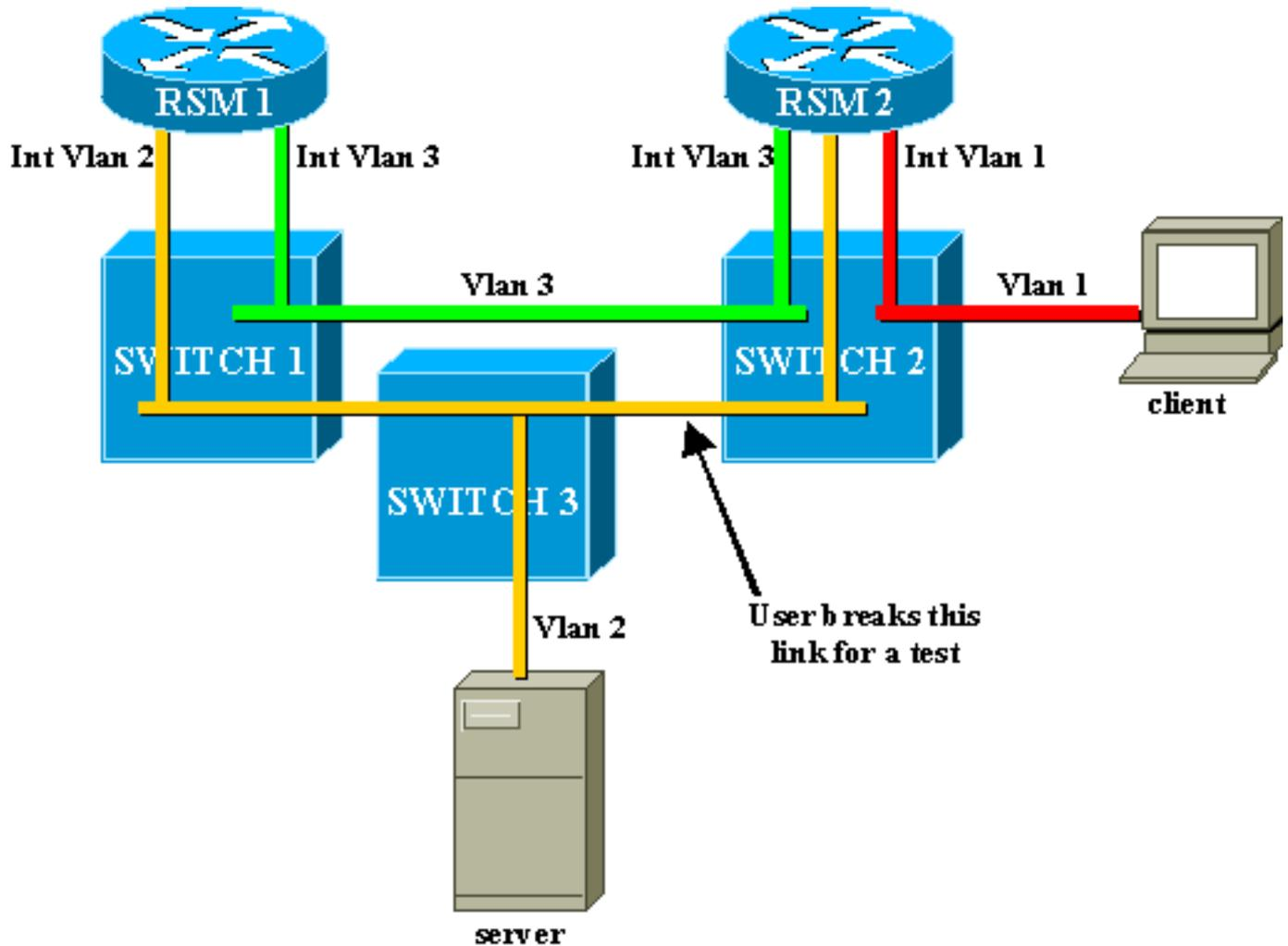
テストを実行するために、ユーザはスイッチ2とスイッチ3の間のリンクを切断します。対応するポートがダウンし、RSM autostate機能によってRSM2のインターフェイスVLAN2がダウンします。サーバに直接接続されたルートは、RSM1経由で新しいルートを学習します。ospf)または Enhanced Interior Gateway Routing Protocol(EIGRP)では、コンバージェンスが非常に高速であるため、この操作中にpingが失われにくくなります。
