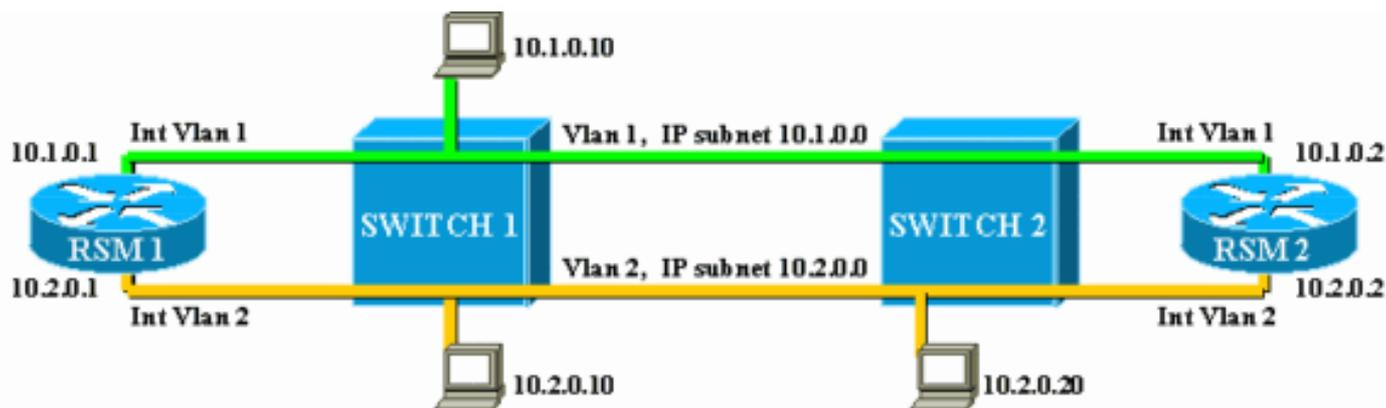
両方のRSMも、インターフェイスVLAN1とVLAN2の間で他のプロトコルをブリッジするように設定されています。LATサービスを提供するホストとそれらを使用するクライアントがあるとします。ネットワークは次のようになります。
