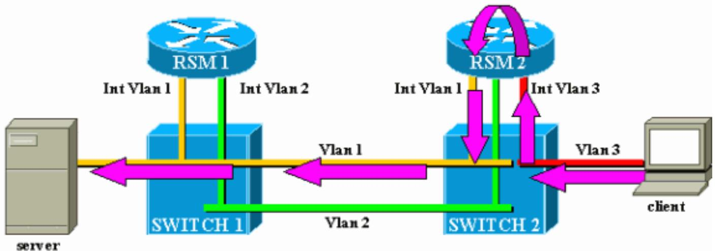
クライアントからサーバへのトラフィックだけを考察します。VLAN3のクライアントからの着信トラフィックはRSM2によってルーティングされます。RSM2は、インターフェイスVLAN2経由でサーバのサブネットに直接接続されています。紫色の矢印は、次のパスを表します。
