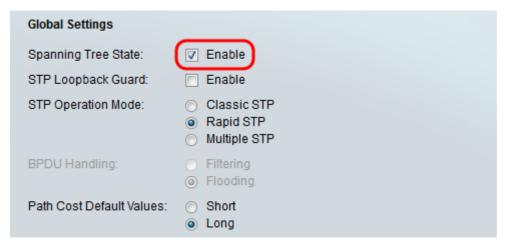
ステップ3:STP Loopback Guardは、レイヤ2転送ループに対する保護を強化します。冗長トポロジのSTPブロッキングポートが誤ってフォワーディングステートに移行すると、ループが発生します。これは通常、物理的に冗長化されたトポロジのいずれかのポート(必ずしもSTP ブロッキング ポートとは限らない)で STP BPDU が受信されなくなったために発生し
