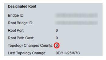
[Last Topology Change] フィールドは、最後のトポロジ変更が発生してから経過した時間間隔です。時刻は日/時間/分/秒の形式で表示されます。
