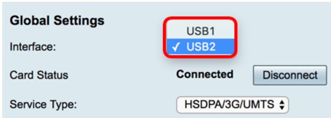
ステップ3: ( オプション ) [Card Status ( カードのステータス )]領域で、USB Dongleが接続されている場合、ステータスが自動的に更新されます。そうでない場合は、[接続]を押します。切断する場合は、[切断]を押します。
