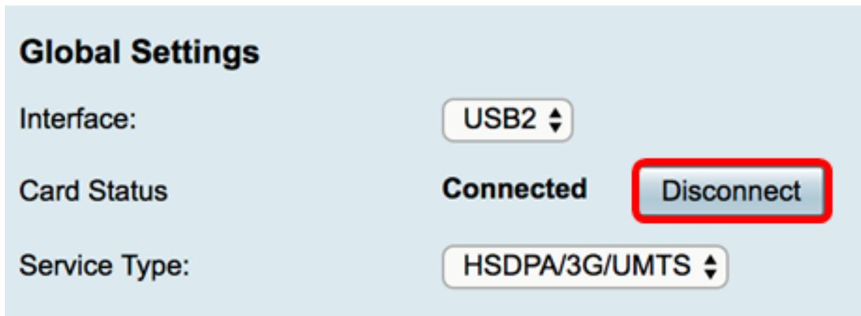
ステップ4:[Service Type ( サービスタイプ ) ]ドロップダウンリストから、エリアサービス信号に基づいて、最も一般的に使用できるモバイルデータサービス接続のタイプを選択します。お客様のロケーションでサポートされているモバイルデータサービスが1つだけの場合は、希望するオプションを制限し、接続のセットアップ時間を短縮できます。次のオプションがあります。
