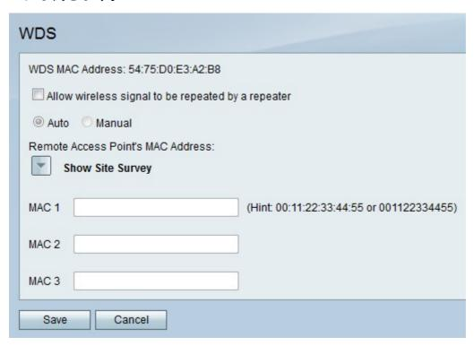
ステップ2:WDSを有効にする**には、[Allow wireless signal to be repetited by a repeater]チェックボックス**をオンにします。
