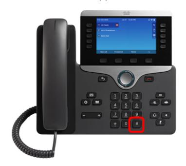
ステップ3:ミュートインジケータライトが消灯したら、すぐにシャープ(#)キーを放し、1、2、3、4、5、6、7、8、9、\*、0、#sequentiallyを押します。上記のすべてのキーを5秒以内に押し終えるはずです。押さないと、リセットプロセスは成功しません。
