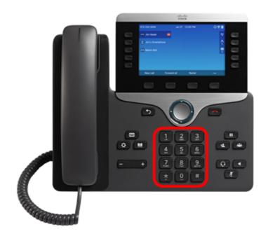
注:キーパッドを押すと、ミュートボタンが点灯 し、リセット処理が開始されたことを示します。電話機が工場出荷時のリセットプロセスを実行している間は、電話機の電源を切らないでください。
