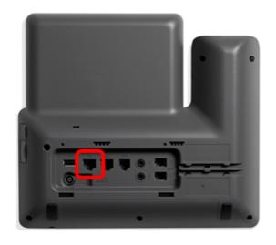
ステップ2:5秒後にPound (#)キーを押し続けて、電話機に電源を再接続します。
