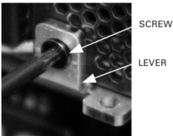
ステップ2：レバーをモジュールから引き離してラッチを解除します。
