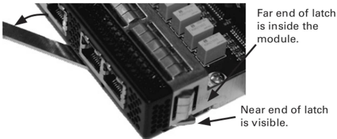
ステップ3：ラッチの遠端がスロットの内側に来て、ラッチの近端がスロットの外側に触れるまで、モジュールをスロットに挿入します。
