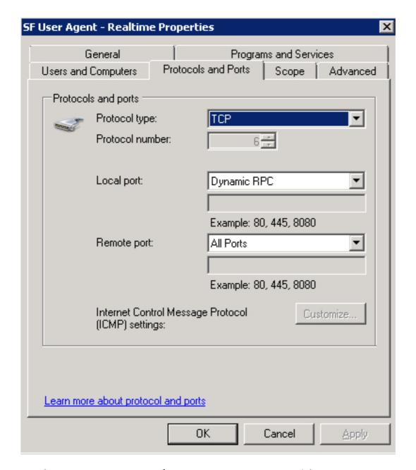
を選択します。 [Scope] タブでリモート IP アドレスを追加します。[Add] をクリックして、User Agent ホストの IP アドレスを入力します。
