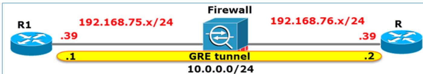
GREトンネルを使用してR1からR2にpingを実行すると、トラフィックはファイアウォールを通過し、図のように見えます。
