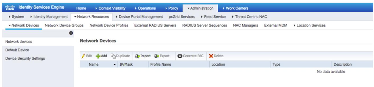
ステップ3 : 必要な値([Name]、[IP Address]、[Device Type]、[Enable TACACS+])を入力し、[Submit]をクリックします。
