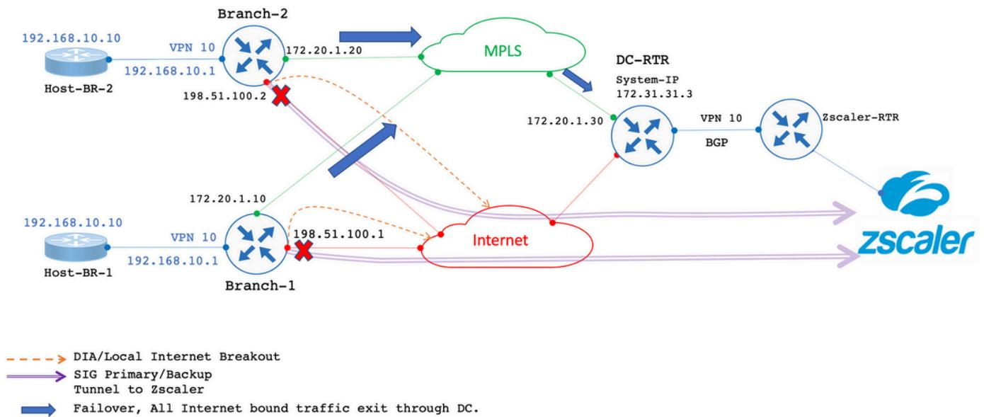
インターネットリンクは、インターネット障害リンクをシミュレートするために、管理上シャットダウンされます。
