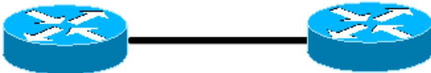
2 つの POS インターフェイス間でバックツーバック接続された 2 つのルータは、直近のシナリオと同じように動作します。SONET オーバーヘッド上で動作する中間機器、または SONET レベルの信号の一部を終了する中間機器がないため、いずれのルータでも障害を迅速に確認することができます。
