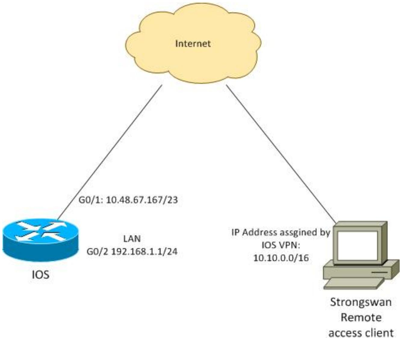
リモートクライアントは、プール10.10.0.0/16からIPアドレスを受信します。10.10.0.0/16 ~ 192.168.1.0/24の間のトラフィックは保護されます。
