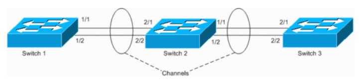
このような設定ミスがあると、トラフィックが誤ってスイッチングされるため MAC アドレスが正しくないポートで学習されて、パケットの損失が発生する危険があります。たとえば、(上の図のように)Hot Standby Router Protocol (HSRP; ホット スタンバイ ルータ プロトコル)を使用するルータが、スイッチ 1 に接続されているものとします。 ルータがパケットをブロードキャストすると、その MAC がスイッチ 2 によってループ バックされて、チャネルからスイッチ 1 によって学習され、ルータから再びユニキャスト パケットが送信されるまでその状態が続きます。
