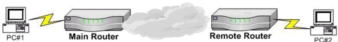
両方のPCでMicrosoftのHyperTerminalを使用するか、いずれかのPCの代わりにCiscoルータのコンソールポートへの接続が可能です。これらの設定例は、ラボのシナリオで以前に設定されていないルータから実装された設定を表し、必要な設定の関連部分を示しています。これらは、9600ビット/秒、8N1接続を前提として設定されています。
