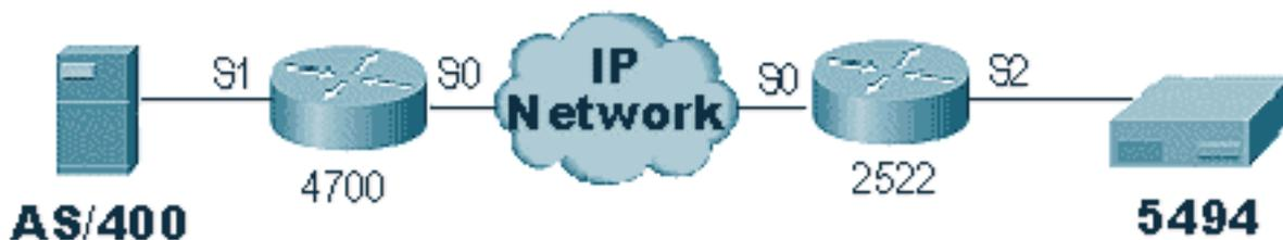
このシナリオには、5494をAS/400に接続するためのSTUN Basic設定があります。STUN設定で最初に確認するのは、ルータでピアが設定されていることです。この確認には、show stun peer コマンドを使用します。このコマンドにより、ピアの状態と、送受信されたパケットに関する情報を入手できます。次に出力例を示します。
