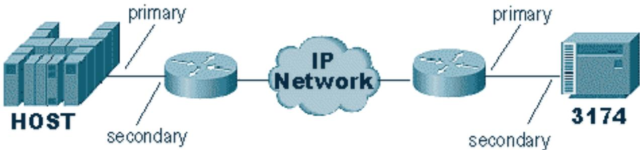
これらのコマンドは、STUN 設定の「ロール」を定義します。上の図のホストの場合、ルータは `primary` に設定されます。つまり、セッションを開始するのはホストです。これにより 3174 はセカンダリになります。STUN Basic を使用している場合、セッションの開始側を把握する必要がないためロールの定義は不要です。ただし、ローカル ACK には回線自体の詳細が必要になるため、ロールを定義することでルータにセッション開始のフローを知らせます。ルータはこれを確認してから、ローカル ACK に移る必要があります。
