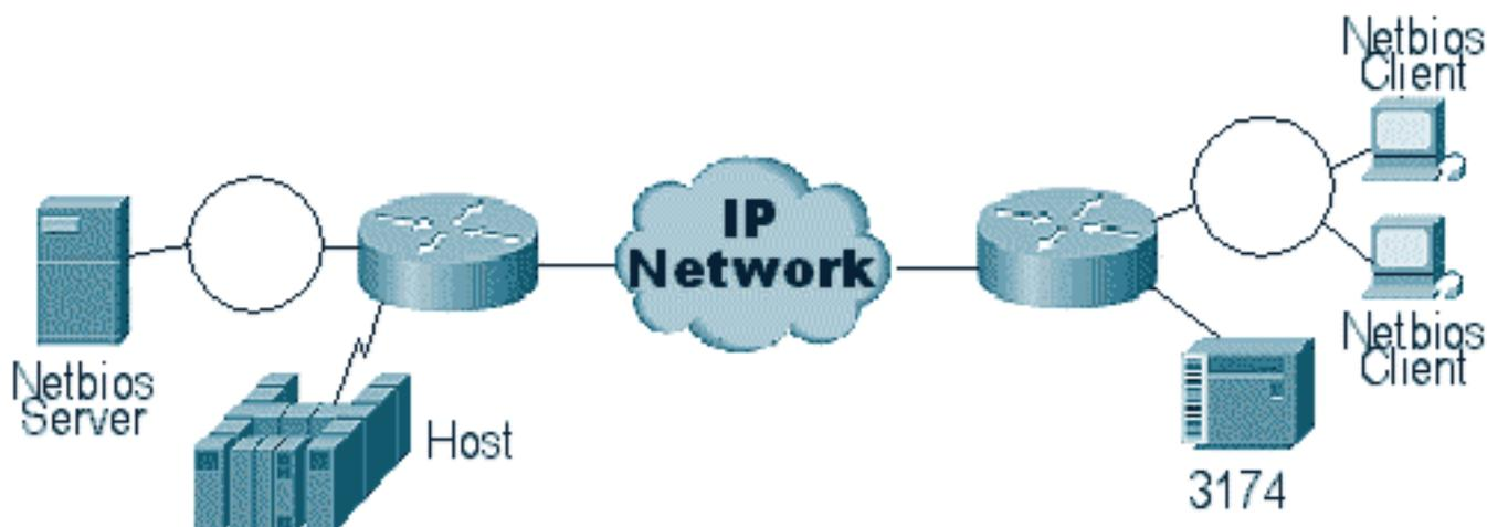
STUN では IP を使用して、Synchronous Data Link Control ( SDLC ) フレームを WAN またはその他のメディアのネットワーク経路で転送することができます。これにより、専用線や POTS を新たに準備する必要がなくなります。Cisco ルータの SDLC 機能の 1 つに、メディア変換機能があります。メディア変換では、ルータがセッションを SDLC から論理リンク制御タイプ 2 ( LLC2 ) に変換します。これについては、「[SDLC から LLC へのネットワークメディア変換の説明とトラブルシューティング](#)」で詳しく説明しています。
