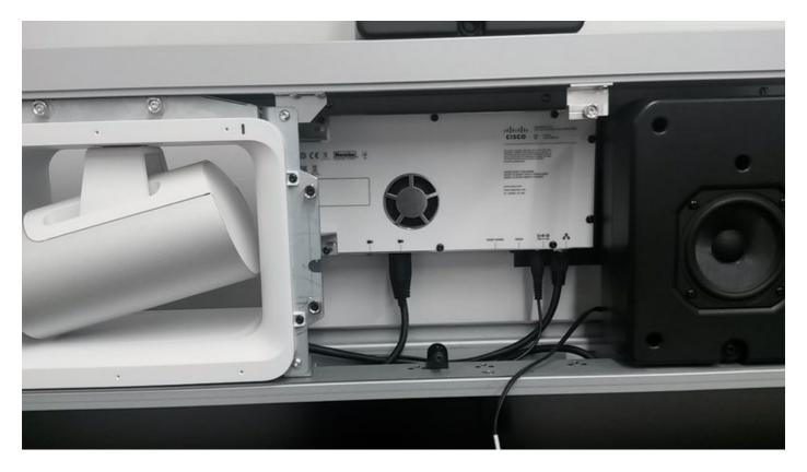
ステップ 4.コントロール パネルの底に、ネジの隣で、ピンホールを表示できます。 カメラの Light emitting diode (LED)がイメージに示すように赤く点滅するまで約 15 秒のペンとのピンホールを押して下さい。
