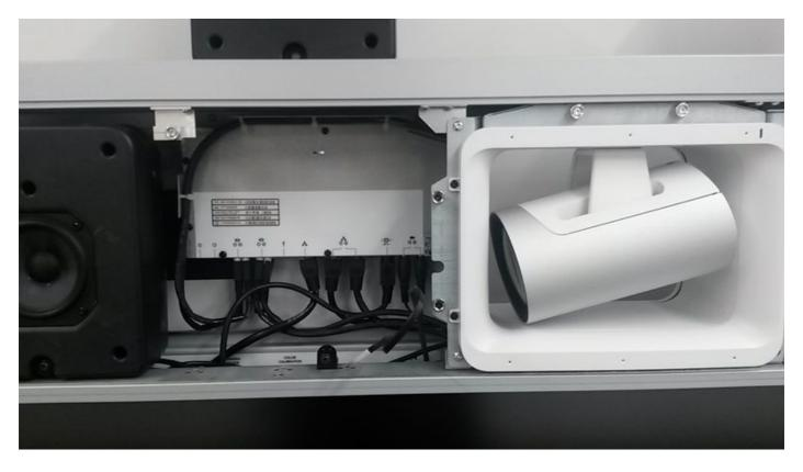
ステップ 6、ネジの隣で見つけることができましたり左下のピンホールをイメージに示すように 約 15 秒のためのピンホール、およびスピーカー トラッカー リセットを押します。
