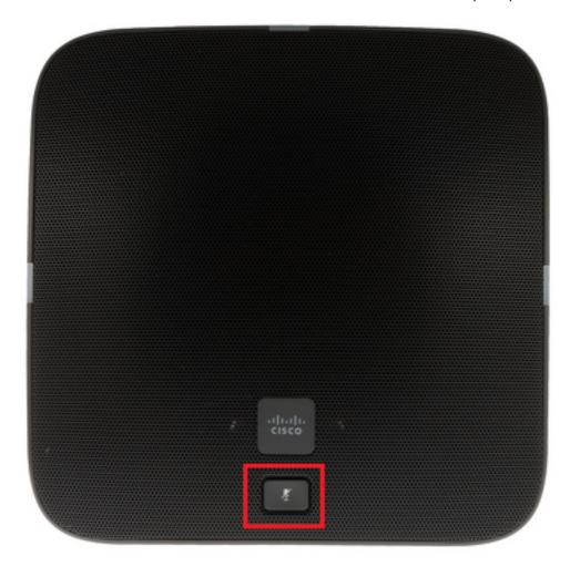
ステップ3:MICボタンを押したまま、電話機の電源をオンにします(イーサネットケーブルまたは電源ブリックを差し込みます)。 電話機の左側、右側、および背面にあるライトが緑色から赤色に変わったら、図に示すようにMICボタンを放します。
