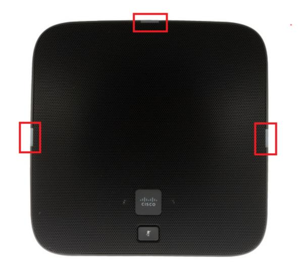
ステップ4:MICボタンを約5秒間押し続けた後、放します。赤いライトが2回点滅します。
