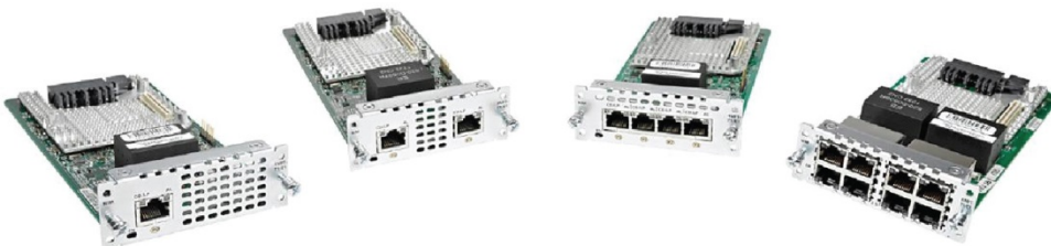
図 6. VG450 と互換性のある Cisco T1/E1 NIM
