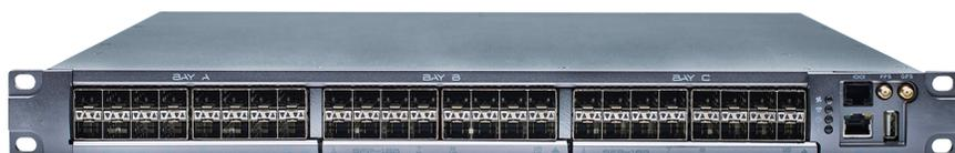
図 3. Cisco Nexus 3550-F Fusion スイッチ
