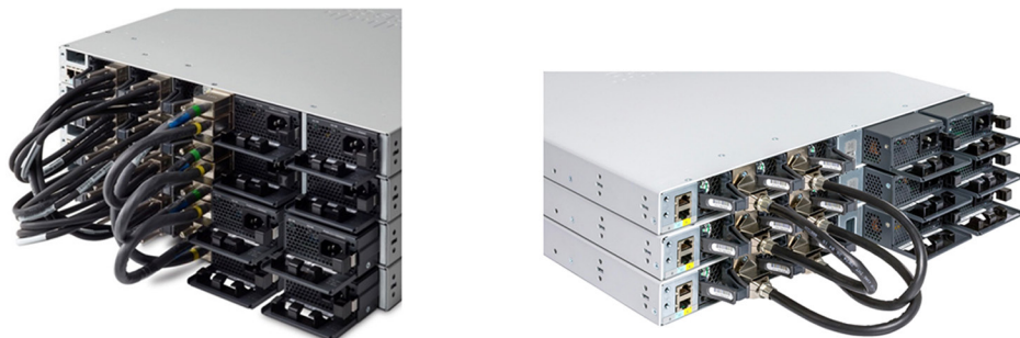
図 5. Cisco Catalyst 9300 シリーズのモジュラ アップリンク モデル スタック (C9300/C9300X SKU) および固定アップリンクモデルスタック (C9300L SKU)
