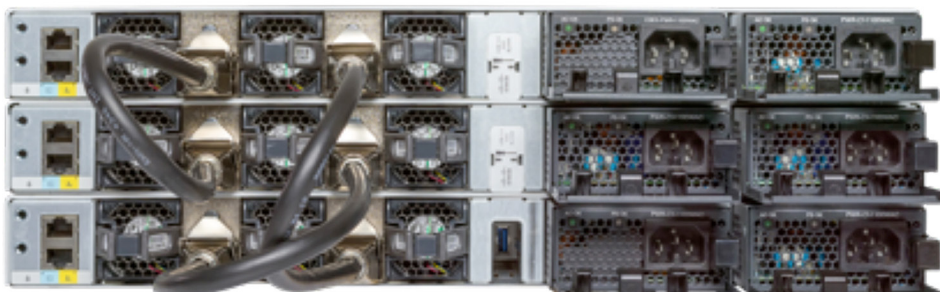
図 6. Cisco Catalyst 9300 シリーズ固定アップリンクモデル、オプションのスタックキット使用
