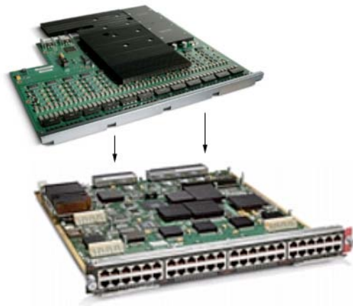
図 7 Cisco クラシック 96ポート 10/100 802.3af PoE モジュール(製品番号 WS-X6148X2-45AF)
