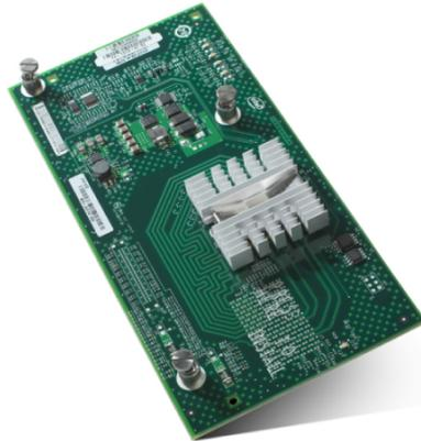
Cisco UCS CNA M61KR-I は、エネルギー効率に優れた 10 ギガビット イーサネット転送機能、I/O 仮想化、ユニファイド ネットワーキングを必要とするデータセンター環境向けのソリューションを提供します。このアダプタは Cisco UCS ブレード用に設計されており、ブレード サーバ シャーシのミッドプレーンにデュアルポート接続されます(図 2)。
