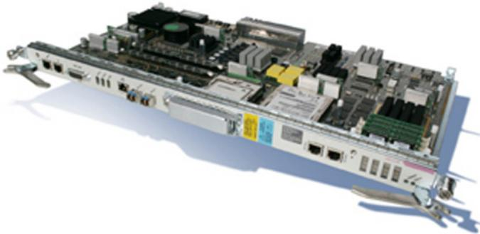
このデータシートは、Cisco CRS-1 8 スロット ライン カード シャーシ ルート プロセッサについての製品仕様を記載するものです。Cisco CRS-1 または Cisco CRS-1 上のその他のインターフェイスの詳細については、次の URL を参照してください。
