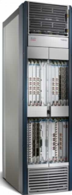
図 1 Cisco CRS 16 スロット シングルシェルフ システム
