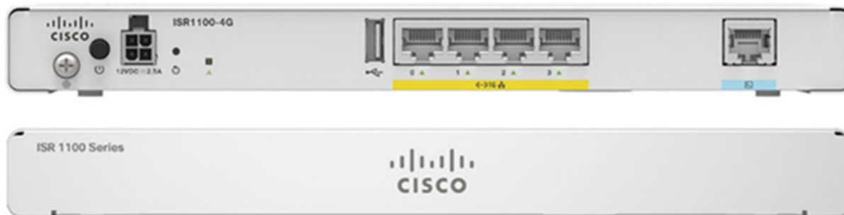
図 1. ISR 1100-4G の正面図と背面図
