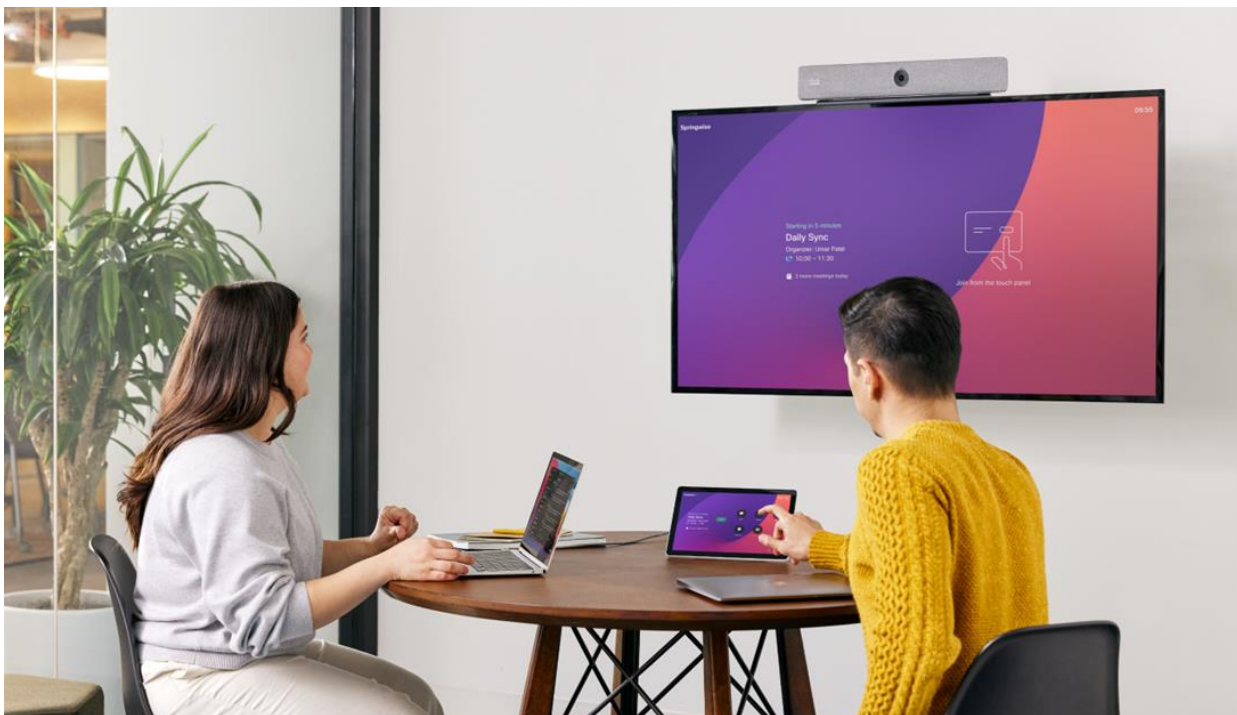
上 : Cisco RoomOS で実行されているネイティブ ルーム コントローラとして使用される Cisco Room Navigator for Table ユニット
