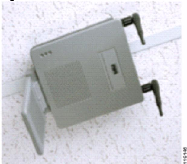
La Figura 22 mostra un'antenna di diversità omnidirezionale Cisco Aironet 5959 montata correttamente su una barra a T a soffitto. In questo caso, il Cisco AP1200 è montato al di sopra del soffitto.
