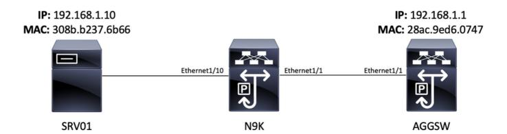
Un pacchetto Internet Control Message Protocol (ICMP) proveniente dal server SRV01 nella VLAN 10 (192.168.10.10) è destinato al gateway VLAN 10 192.168.10.1. Verrà utilizzata una sessione di monitoraggio SPAN-CPU per confermare che il pacchetto ICMP attraversa il dispositivo N9K (un Cisco Nexus 93180YC-EX con software NX-OS versione 9.3(3)), che agisce come switch di layer 2 che si connette da SRV01 a AGSW nella VLAN 10.
