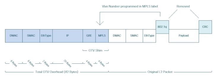
Nelle soluzioni MPLS L2VPN, i dispositivi nella rete sottostante non dispongono di informazioni sufficienti per decodificare correttamente il payload del pacchetto MPLS. In genere, questo non è un problema, poiché l'inoltro dei pacchetti in una rete principale MPLS viene eseguito in base alle etichette, non è necessaria un'analisi approfondita del contenuto dei pacchetti MPLS nella rete sottostante.
