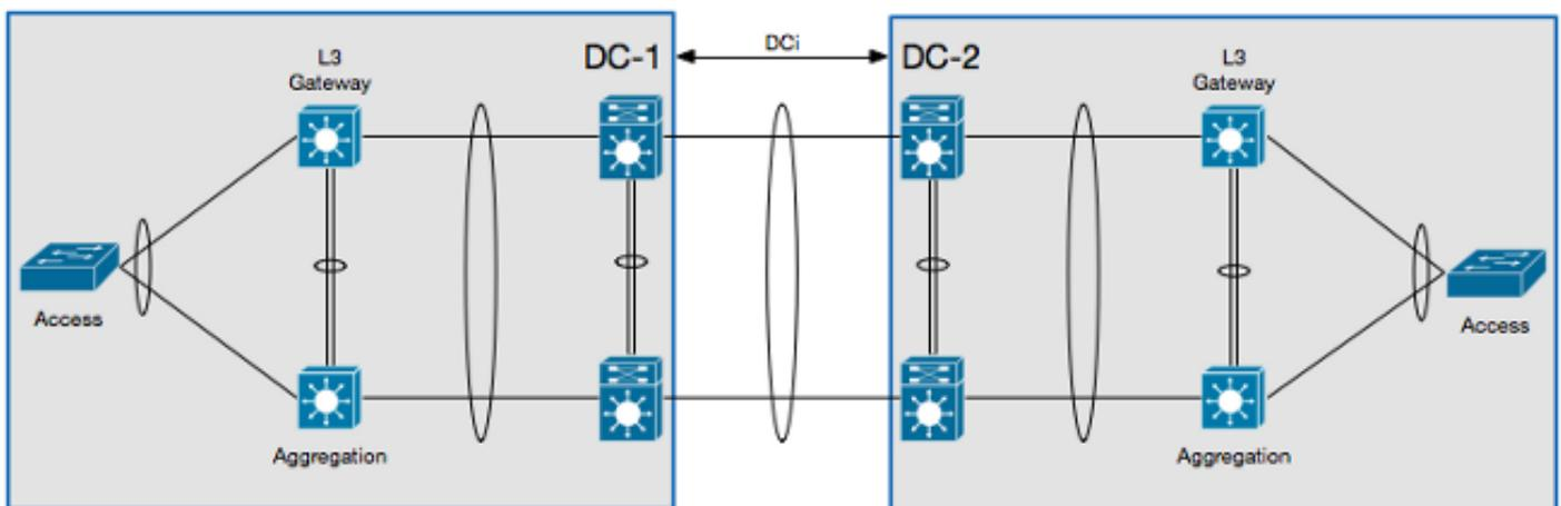
In questo scenario, il DCI viene isolato nel proprio contesto di dispositivo virtuale L2 (VDC) e il gateway L3 si trova su un dispositivo a livello di aggregazione. Per isolare l'HSRP, è necessario configurare un elenco di controllo di accesso VLAN (VACL) che blocchi il traffico di controllo dell'HSRP e un filtro di ispezione ARP che blocchi i GARP HSRP sul VDC L2 DCI.
