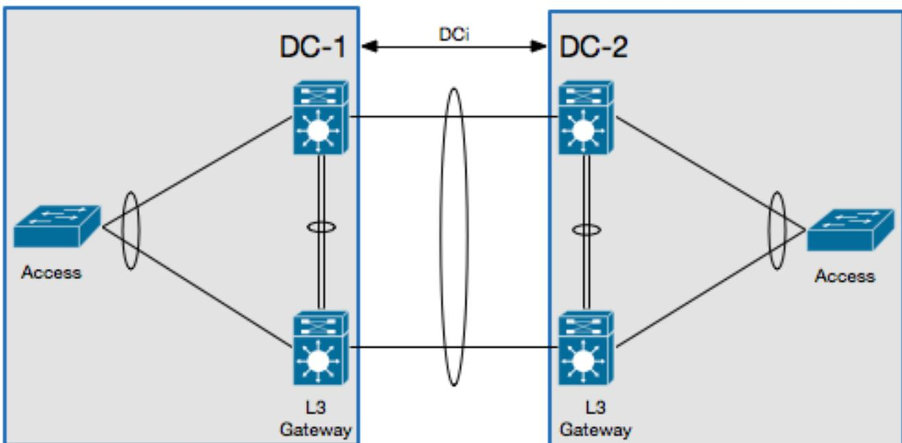
In questo scenario, il gateway di layer 3 (L3) è configurato sulla stessa coppia vPC e funge da DCI. Per isolare l'HSRP, è necessario configurare un elenco di controllo di accesso (ACL) delle porte sul canale DCI e disabilitare i protocolli ARP (Gratuitous Address Resolution Protocol) (GARP) dell'HSRP sulle interfacce virtuali commutate (SVI) per le VLAN che si spostano attraverso il DCI.
