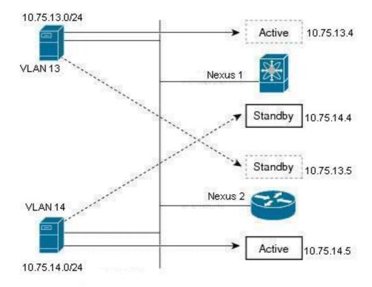
Questo è un esempio di HSRP, con due router (Nexus 1 e Nexus 2) e due utenti di gruppo (VLAN 13 e VLAN 14). Con la configurazione indicata di seguito, il Nexus 1 è il router attivo per gli utenti della VLAN 13 e il router di standby per gli utenti della VLAN 14; Nexus 2 è un router attivo per gli utenti della VLAN 14 e un router in standby per gli utenti della VLAN 13. Il traffico verrà condiviso da questi due router nexus e verrà fornita anche la ridondanza di routing del primo hop.
