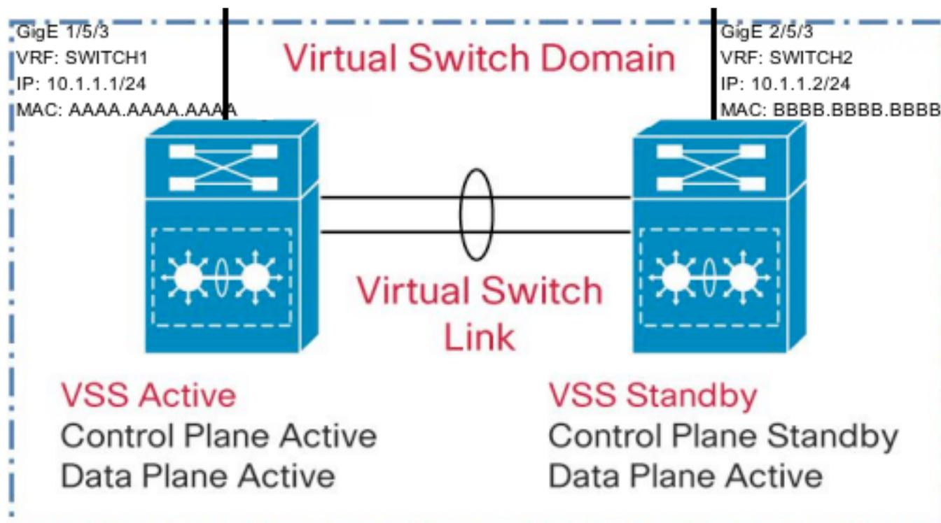
1) È necessario escludere un'interfaccia su ciascuno switch nel VSS dallo spegnimento durante il rilevamento dual-active come indicato di seguito.
