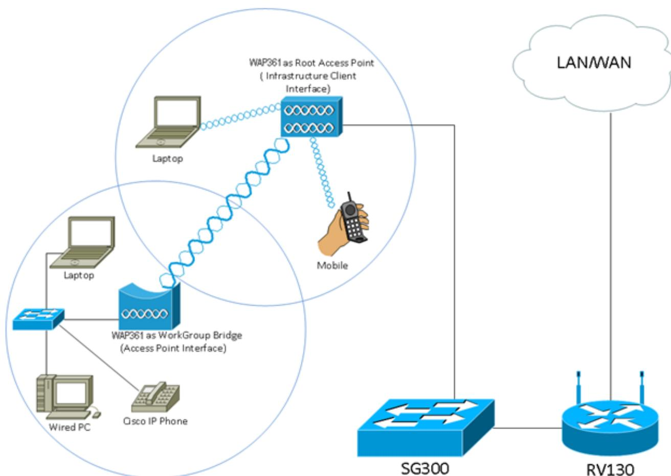
Nota: la topologia sopra riportata illustra un modello di esempio di WorkGroup Bridge. I dispositivi cablati sono collegati a uno switch, che si connette all'interfaccia LAN del WAP. Il WAP agisce come interfaccia di un punto di accesso e si connette all'interfaccia dell'infrastruttura.
