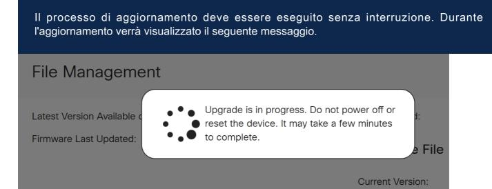
Al termine dell'aggiornamento, verrà visualizzata una finestra di notifica per informare che il router verrà *riavviato* con un conto alla rovescia del tempo stimato per il completamento del processo. In seguito, si verrà disconnessi.
