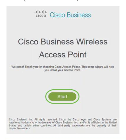
questa configurazione iniziale, utilizzare https://ciscobusiness.cisco per eseguire il login. Se il browser Web viene compilato automaticamente con http://, per ottenere l'accesso è necessario digitare manualmente il testo https://.
