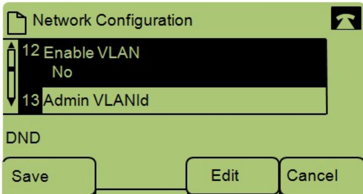
Passaggio 4. Selezionare Enable VLAN — Nota: Premere \*\*# per sbloccare o bloccare determinate opzioni di modifica sul telefono.
