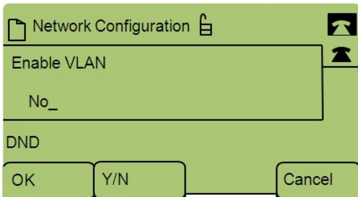
Passaggio 6. Premere **Y/N** per passare da Yes (Sì) a No e viceversa per abilitare o disabilitare la VLAN.
