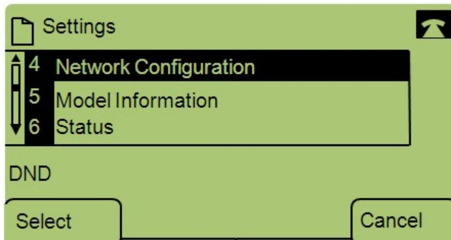
Passaggio 3. Passare a Configurazione di rete e premere Select utilizzando il tasto software.
