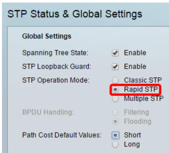
Passaggio 5. (Facoltativo) Scegliere la modalità di gestione BPDU. la modalità di gestione BPDU è disponibile solo quando lo stato dello Spanning Tree non è abilitato.
