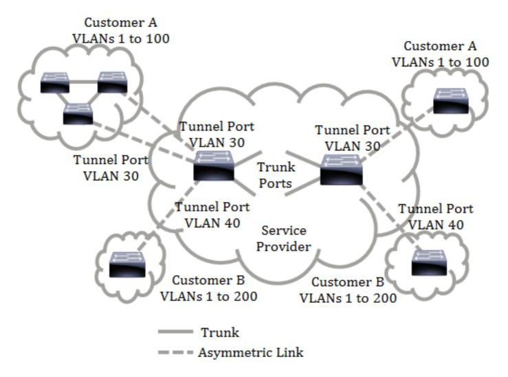
Èpossibile mappare gli ID C-VLAN agli ID S-VLAN per i viaggi dei pacchetti sulla backbone del provider di servizi. Gli ID delle C-VLAN vengono recuperati sull'altro lato della backbone del provider di servizi per essere utilizzati nell'altra sede del cliente. È possibile configurare lo stesso insieme di mapping di VLAN su una porta connessa al cliente su ciascun lato della rete del provider di servizi.
